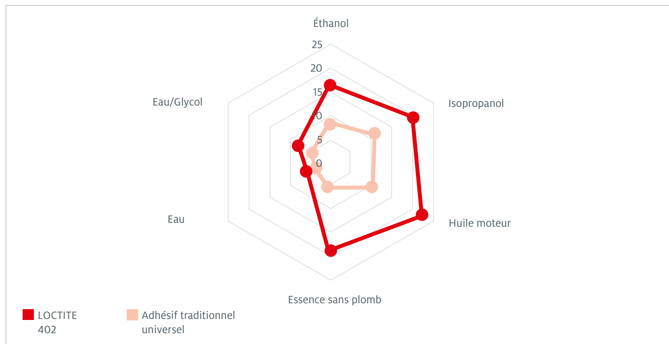
Figure 12 Résistance à la traction (N/mm²) pour LOCTITE 402 et un adhésif traditionnel universel sur de l'acier inoxydable après 1000 heures de vieillissement environnemental avec divers solvants/supports.
